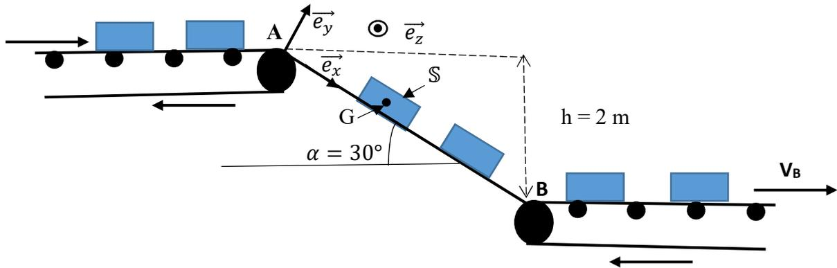
Déterminer la vitesse  $V_B$  du second tapis roulant assurant le fonctionnement correct de l'ensemble.
